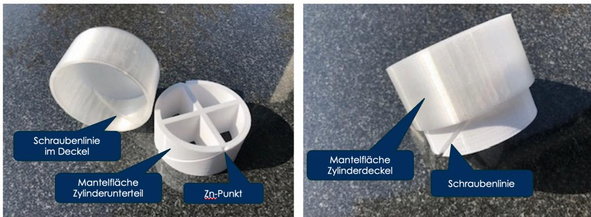
Bild 9: Z4-Zylinder mit Ober- und Unterteil, Schraubenlinie:  $m=2h/r$
